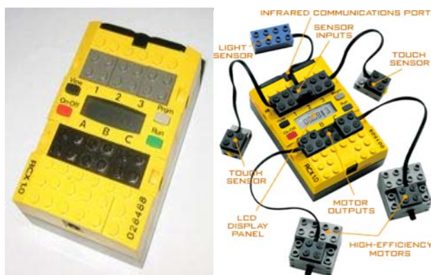
Figura 1 - O RCX: a unidade de controlo do sistema Lego Mindstorms e respectivos interfaces
